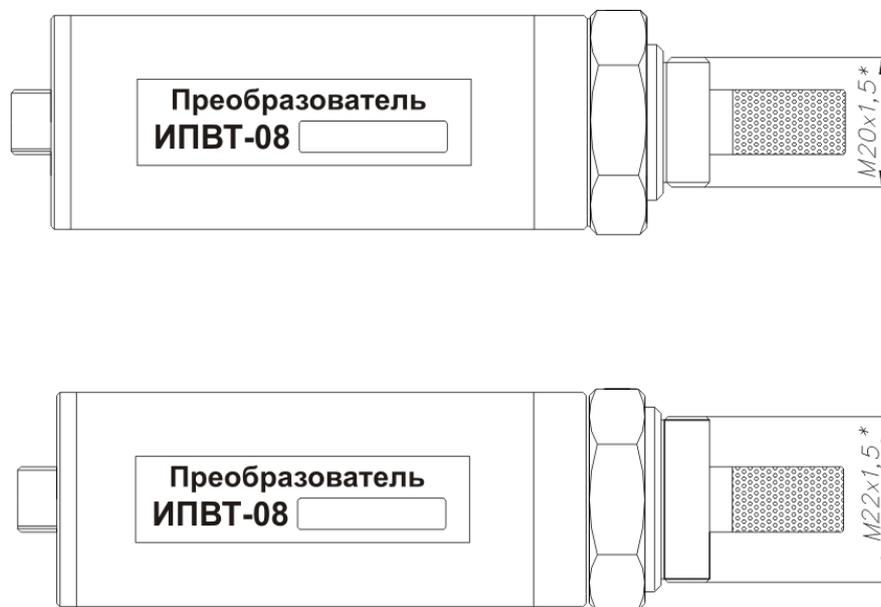
Рисунок А6 Преобразователи ИПВТ-08-03-ДГ(-ПС) (М20)-01, ИПВТ-08-03-ДГ(-ПС) (М22)-01
